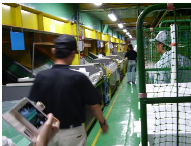
(写真 15) 成形機から排出された製品は、 直接階下の検査工程へ
