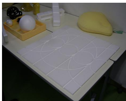
(写真6) 発泡スチロール製品 ロボットトレイと球状のボイド材 (左上)と、床暖房の保温材 (手前；温水管を通す溝が切られて いる)
